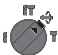
Pārslēdzēja stāvoklis Vario-Lock , kas ļauj regulēt kalta stāvokli Šajā stāvoklī darba režīma pārslēdzējs 13 nefiksējas.
