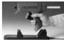
Volver a recargar en la estación de reposo insertando la pistola en el enchufe de contacto móvil (p.ej. cuando el avance mecánico vaya más forzado o salga el pegamento más espeso).
