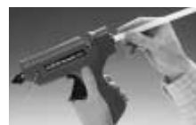
Introduire le bâton de colle dans le conduit de chauffe. Brancher le câble ou...
