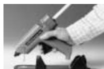
Nach max. 5 min. die Pistole mit einer Vorwärtsbewegung von der Ladestation trennen. Nicht nach oben abziehen.
