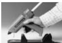
Ota pistooli pois latausasemasta enintään 5 minuutin kuluttua liikkuttamalla sitä eteenpäin. Älä yritä poistaa suoraan nostamalla.
