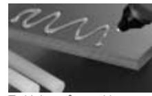
Trykk lett på avtrekkeren for å skyve limstiften fremover. Påfør limet på den ene delen som skal limes og press delene hardt sammen. Etter ca. 2 min. kan limforbindelsen belastes.
