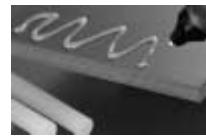
Nakładaj klej na jeden z łączonych elementów przez przymięknięcie spustu. Ścisnij łączone elementy ze sobą. Po ok. 2 minutach połączenie jest gotowe.
