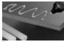
Zum – einseitigen – Auftragen des Klebstoffs leicht den Vorschub-Abzug betätigen. Die zu verklebenden Teile fest zusammenpressen. Nach ca. 2 min. ist die Verbindung belastbar.
