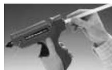
Lijmpatroon achter in het verwarmingskanaal steken. Stekker in het stopkontakt steken of...
