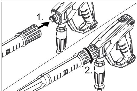
→ Montera munstycke på strålröret (markering upp till på inställningsringen) och dra åt för hand (EASY!Lock).
