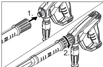
→ Monter la buse sur la lance (marquage sur la bague de butée en haut) et serrer à la main (EASY!Lock).
