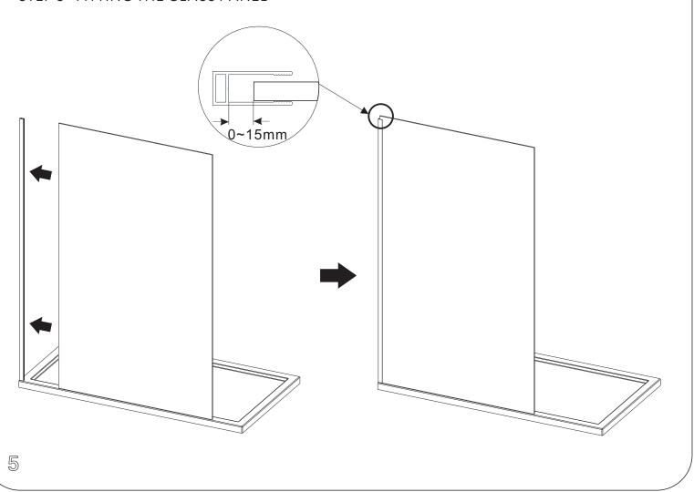
STEP 6 FITTING THE WEDGE GASKET SEAL
