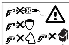
Den Wasserstrahl nie auf das Gesicht von Menschen und Tiere, das Gerät selbst oder elektrische Teile richten.
