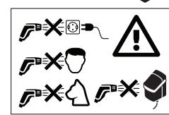
لا تقم برش الماء إطلاقاً على وجه الأشخاص أو الحيوانات أو على الجهاز نفسه أو على الأجزاء الكهربائية.
